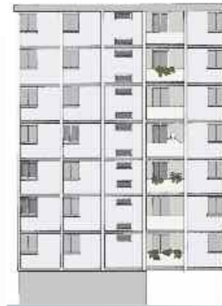
Nuancier 1 : Gris Façade : 1005-R60B Soubassement : 3000N Fond de loggia : 1502-R Balcon : 1000N Menuiseries : 0510-R70B
