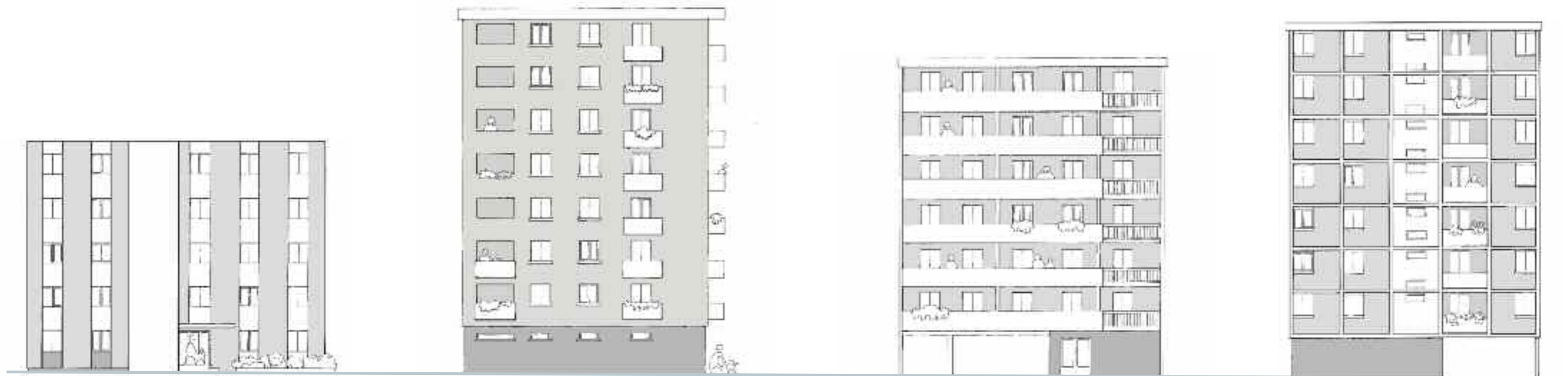
Soubassements fonçés - façades moyennes - balcons, allèges clairs - fond de loggias marqué.
