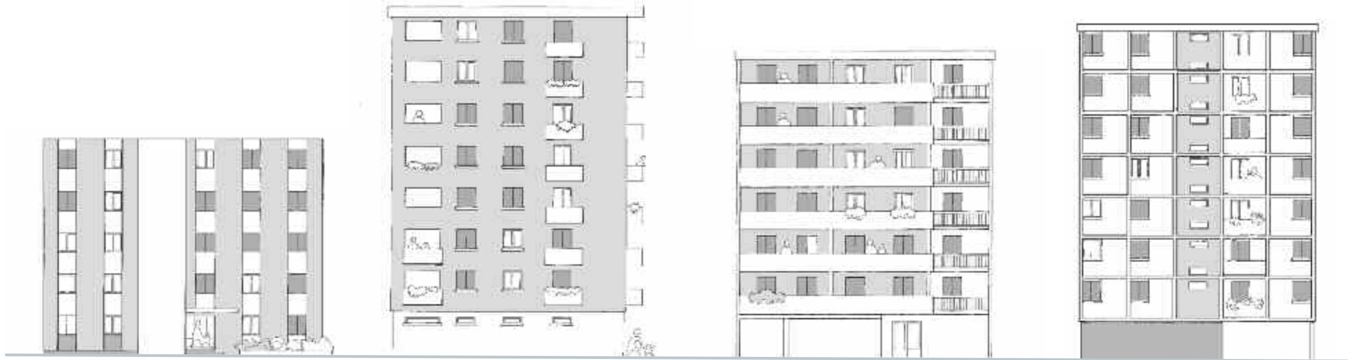
Soubassements fonçés - façades moyennes - balcons très clairs - menuiseries fonçées
